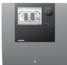
Дифференциально – температурный солнечный контроллер нового поколения Basis Pro предназначен для управления системой состоящей нескольких полей солнечных коллекторов и двух накопителей тепловой энергии. Четыре выхода для управления контурами 3-х ходовыми смесителями. 10 выходов для датчиков PT 1000. Инсоляционный датчик, 30 ранее сконфигурированных гидравлических схем. Поддержка SD карт.
